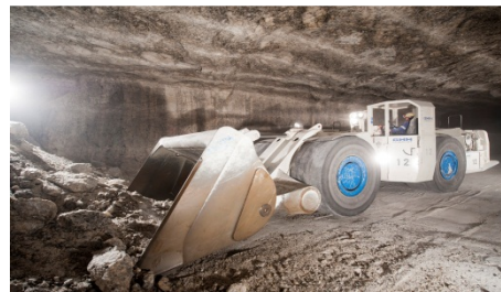
Schritt 6: Der Elektrofahrlader lädt Salz und transportiert es zum Brecher.
