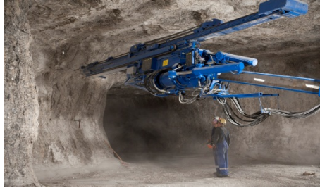
Schritt 2: Modernste, computergesteuerte Bohrwagen erstellen 70 Sprenglöcher.
