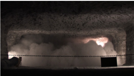
Schritt 4: Sprengen des Salzgesteins.
