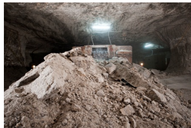
Schritt 7: Der Brecher zerkleinert das Salz für den Weitertransport auf dem Förderband.
