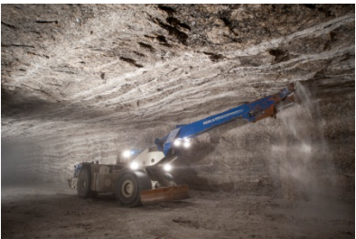
Schritt 5: Das Beraubegerät entfernt loses Steinsalz vom „Streckendach“. So werden Unfälle durch „Salzfall“ vermieden.
