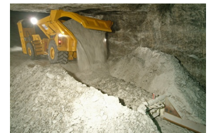
Schritt 2: Das Schiebekastenfahrzeug transportiert das Salz vom CM zum Aufgabeförderer am Förderband.
