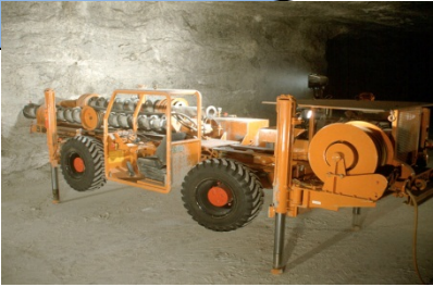
Schritt 1: Der Großlochbohrwagen erstellt ein Hilfsloch für die Sprengarbeit.
